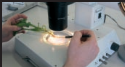
Foto 2. Met de microscoop wordt de aard van de aantasting onderzocht. Onder andere bodemschimmels, aaltjes of insecten kunnen een slechte groei veroorzaken. Aantasting door insecten of aaltjes is al snel te herkennen. Bodemschimmels worden op een voedingsbodem verder opgekweekt. Soms is een lage pH de oorzaak van de slechte groei.
